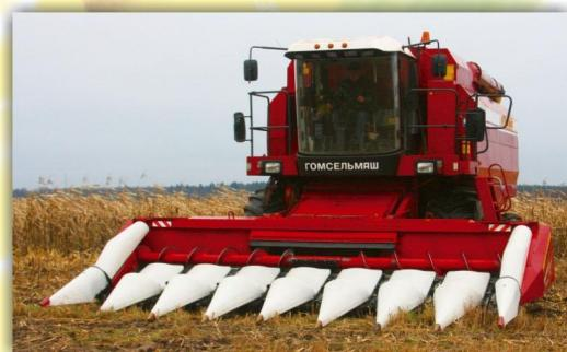
Для оптимизации уборки кукурузы в состав комплекта КОК входит понижающий редуктор оборотов молотильного барабана. Что позволяет снизить дробления зерен кукурузы до минимального значения.
