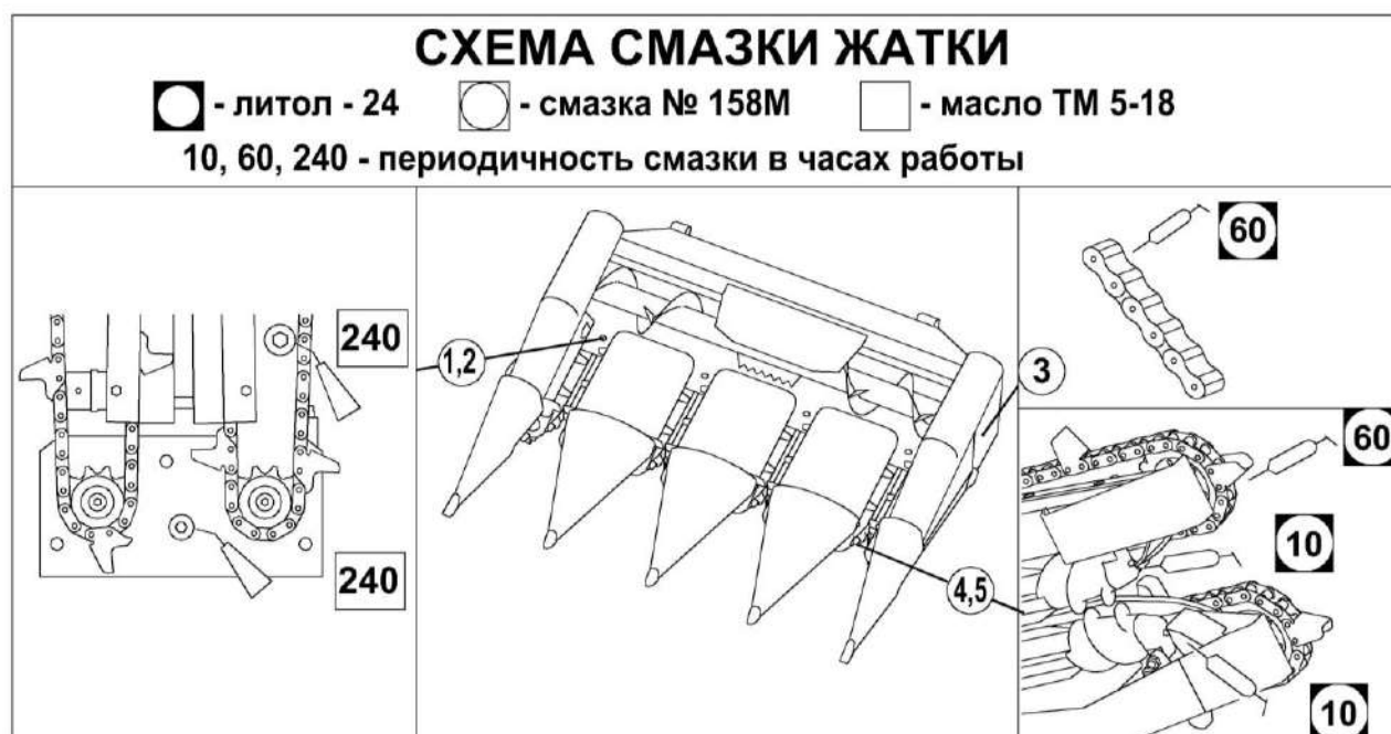
Рисунок 3.1 – Схема смазки жатки
