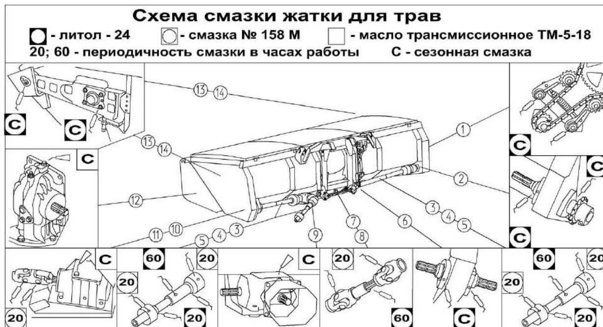
Рисунок 3.1 – Схема смазки жатки
