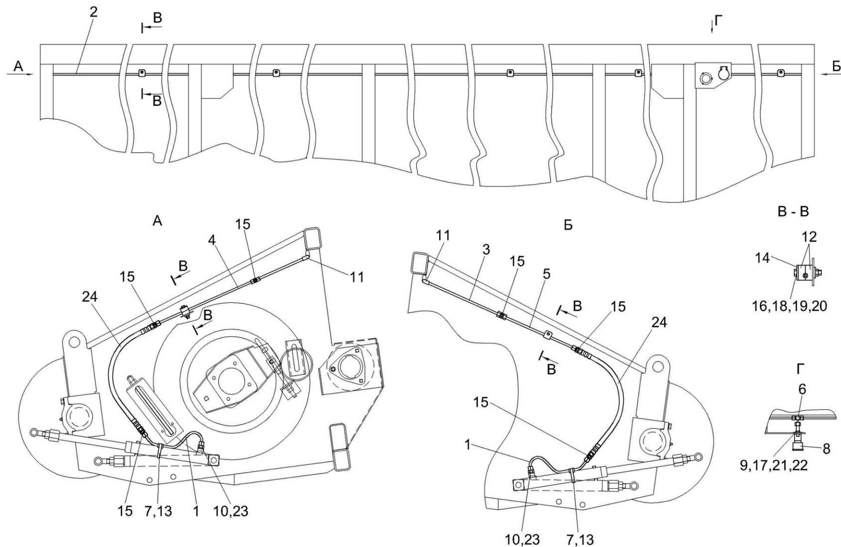
Рисунок 27 – Система гидравлическая подборщика зернового ПЗЗ 1980000
