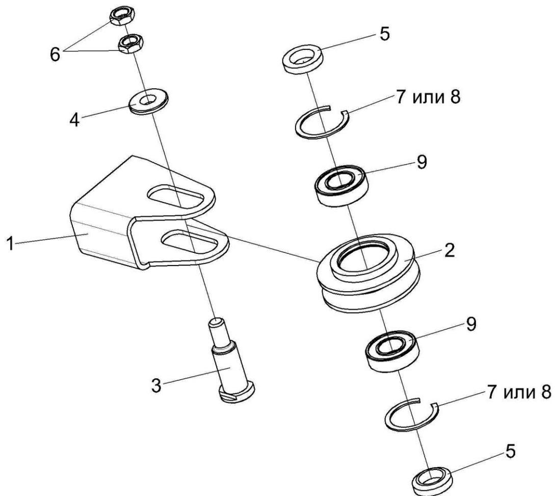
Рисунок 10 – Ролик КЗР 1905000
