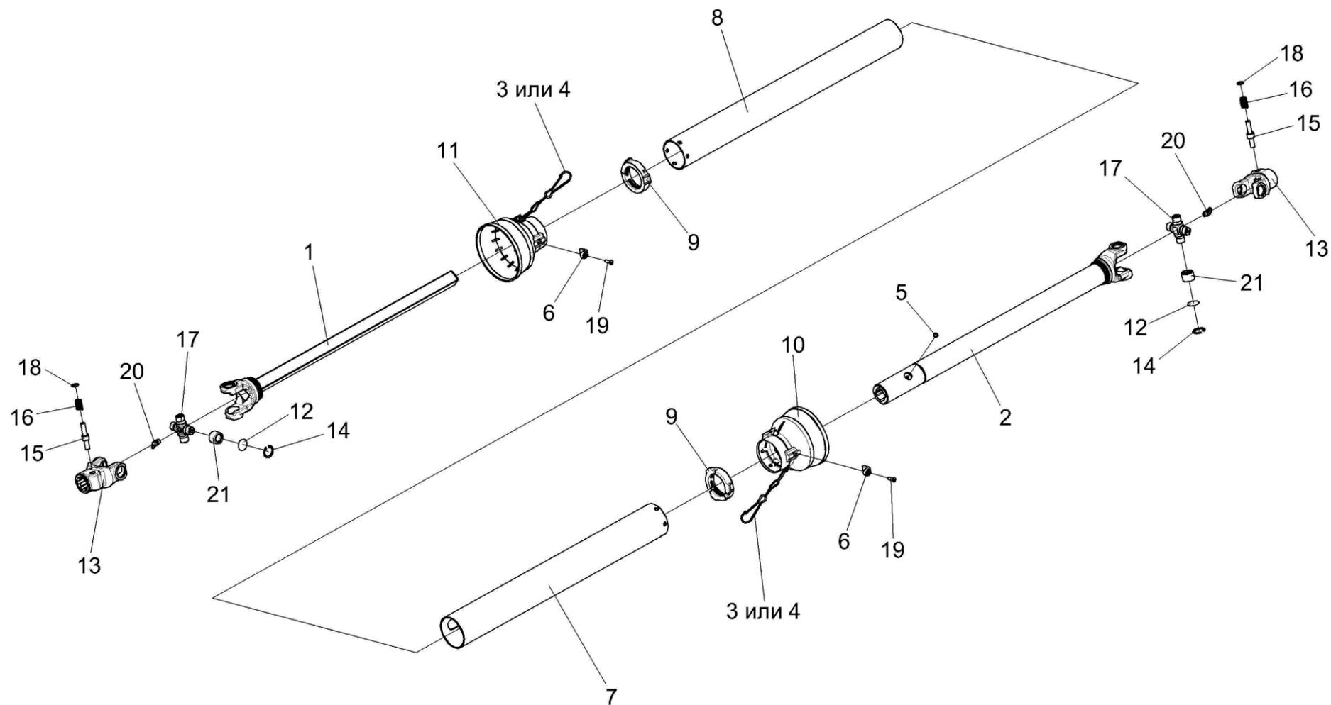
Рисунок 17 – Вал карданный телескопический ПЗЗ 1909000
