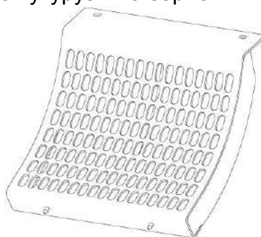
Рисунок 1.4 – Дека переднего подбарабannya
